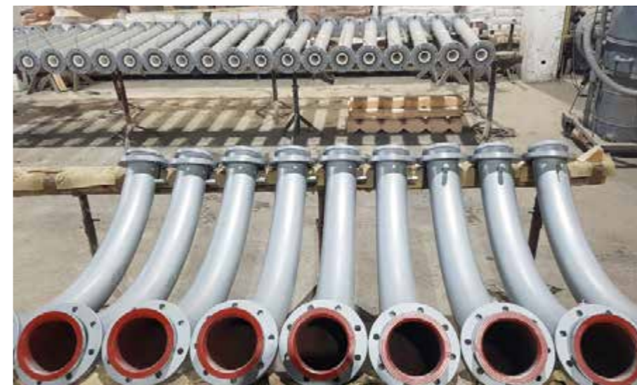
Gezogene Rohrbögen Radius 1000, 60° vor dem Auskleiden und bereits fertige gerade Rohre im Hintergrund
